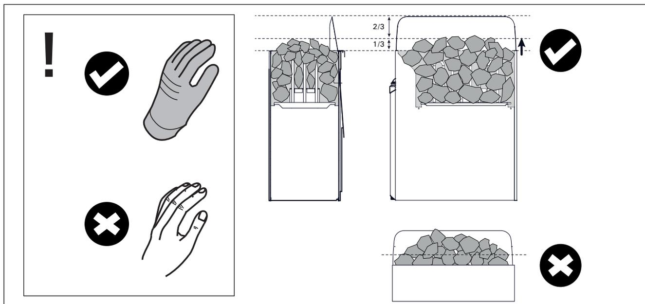
Figure 1. Mise en place des pierres du poêle
