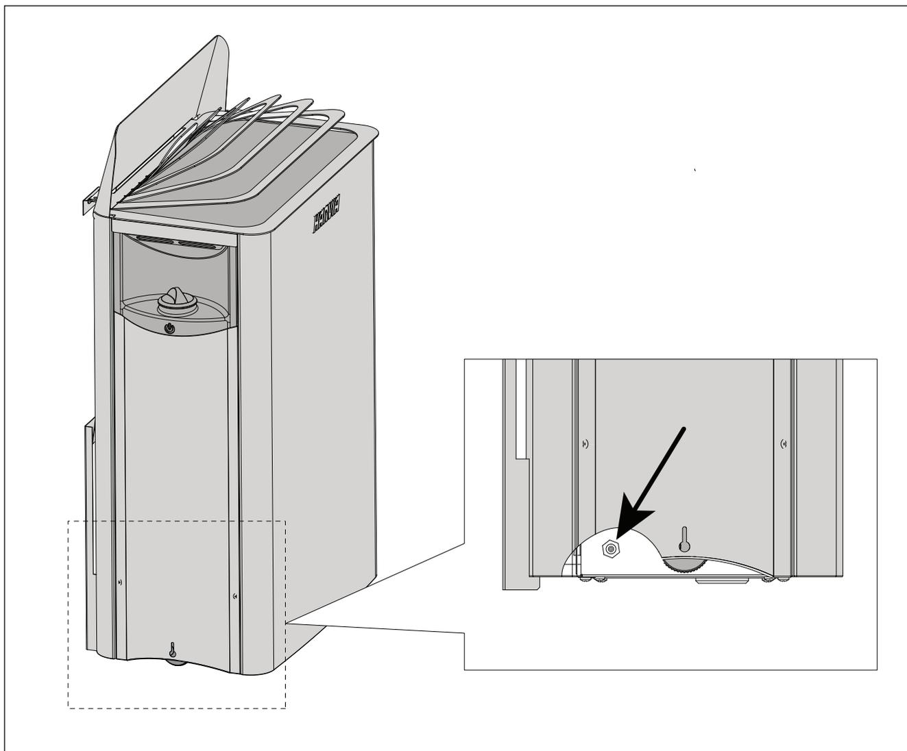
Figure 8. Réinitialiser les boutons pour les sécurités surchauffe.
